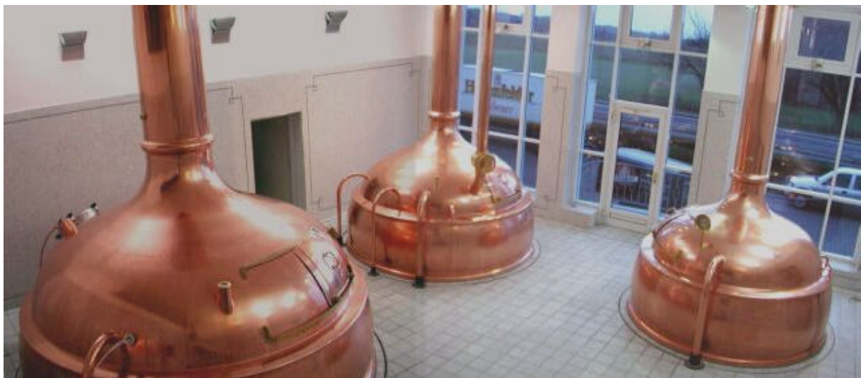
Bild 1: Bestehendes Sudhaus mit Kupferhauben
