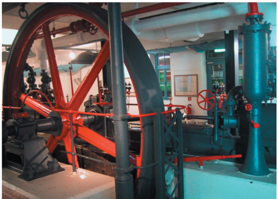
Abb. 1 Linde'sche Eismaschine im historischen Paulaner Eiswerk
