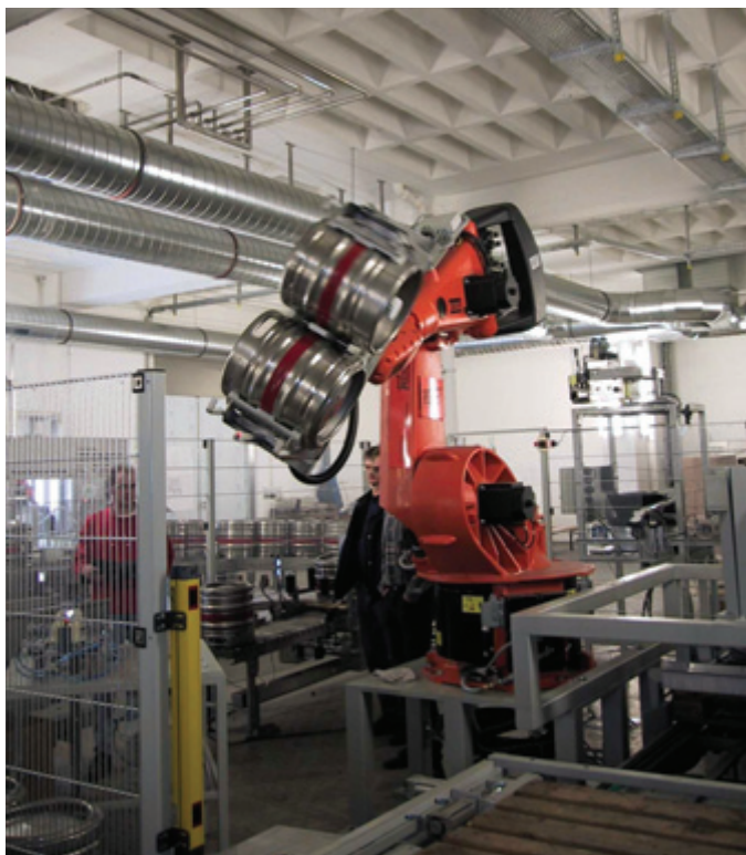
Abb. 3 Multifunktionaler Roboter in der Keganlage der Brauerei Weihenstephan
